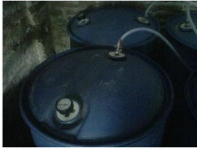
**Gambar 3. Drum sebagai penampung hasil biogas yang dirangkai dengan selang**
